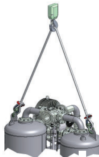
Transporte con grúa
